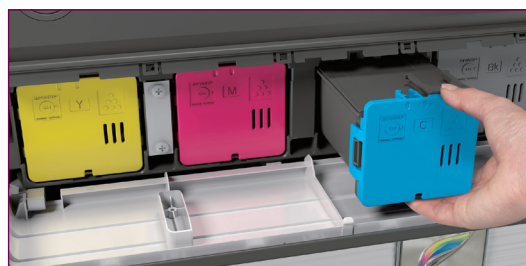
A festékkazettákat csak akkor adja ki automatikusan a készülék, ha kiürültek.
